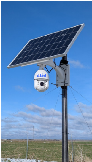
DTBird PTZ autónomo (ángulo de visión horizontal de 55° a 15°).
